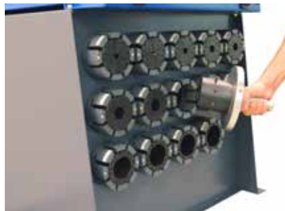
Ruotare e togliere la serie di morsetti
